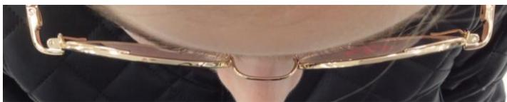
(Monture non galbée avec des soudures fragiles)
